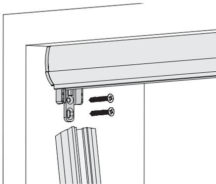
So kann z.B. das Rollo problemlos zwischen Fenster und Rollladenführungsschiene montiert werden (Platzbedarf 40 mm).
