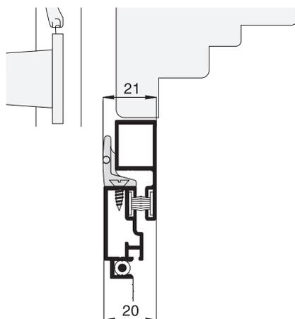
Bei Drehrahmen mit den Montagerahmen 10 35 21, 10 35 24 und 10 35 31 ist der Türschließer im Montagerahmenprofil untergebracht. Dadurch benötigt man keinen zusätzlichen Platz bei der Montage.
