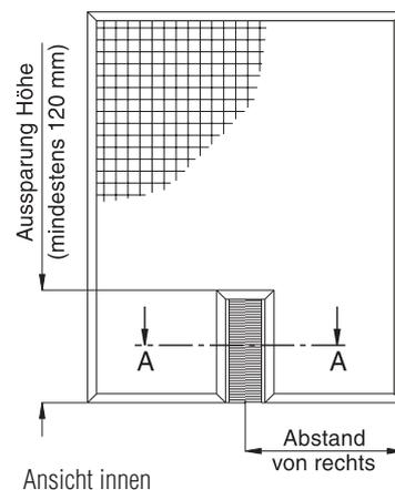
Die Aussparungen für die automatischen Fensteröffner werden über ein h-Profil mit Streifenbürste abdichtet. Es stehen dabei 2 verschiedene Größen zur Verfügung.
