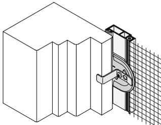
Für eng anliegende Rollladenführungsschienen kann der Spannrahmen um 6 mm eingerückt werden.
