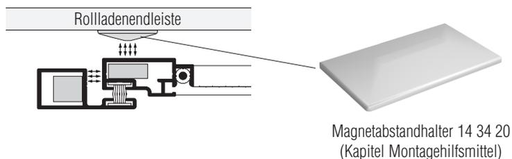
Sie haben auch die Möglichkeit, den Beschwerungsstab in der Rollladenendleiste im Bereich der Magnete zu kürzen.
