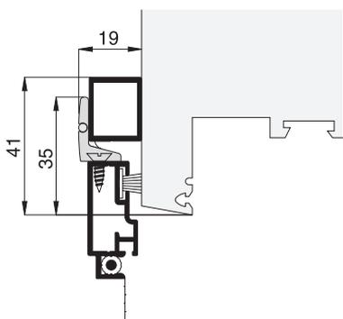
Bei Drehrahmen für Türen ohne Montage-rahmen ist der Türschließer in dem Rohrprofil 10 35 22 (Profile, Seite 29) untergebracht. Dieses wird oberhalb der Tür am Blendrahmen montiert (siehe Skizze).
